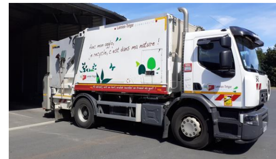
BOM de PTAC 19 tonnes
