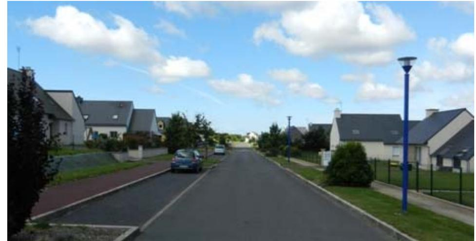
Cette voie de desserte d'un lotissement mesure 15 mètres de large. Elle comporte deux bandes gazonnées inutiles, deux trottoirs au lieu d'un, et des stationnements nombreux. Une importante économie d'espace aurait pu être réalisée.
