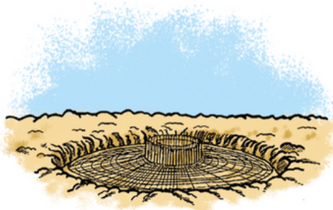
Pose de la cage d'ancrage
