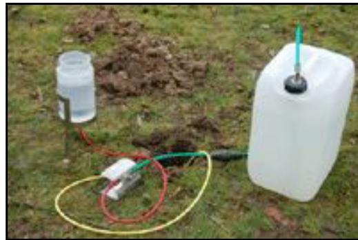
Figure 33 : Matériel utilisé pour la réalisation des tests de perméabilité
