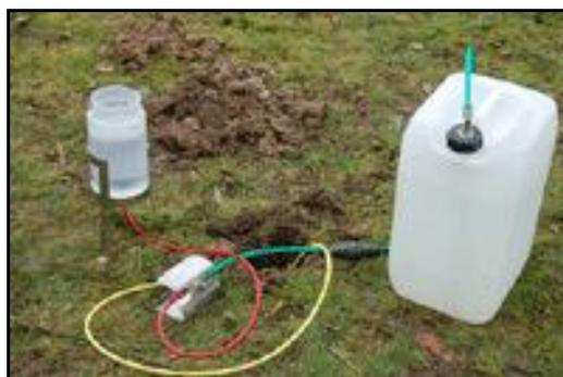
**Figure 16 : Matériel utilisé pour la réalisation des tests de perméabilité**
