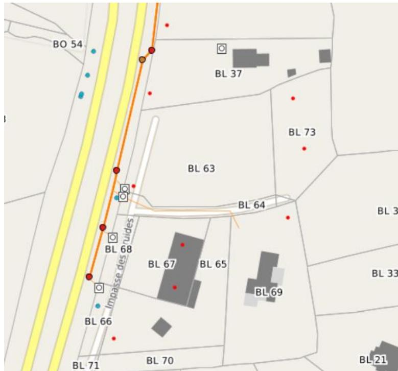
**Figure 4 : Schématisation du réseau et des boîtes de branchement**
