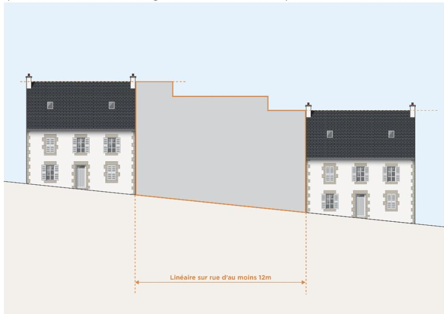
*Schéma pour l'implantation d'une nouvelle construction sur un linéaire de façade d'au moins 12 m, sur un terrain en pente © BE-AUA*
