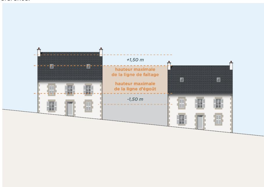
*Schéma hauteur des constructions neuves, sur terrain en pente © BE-AUA*
