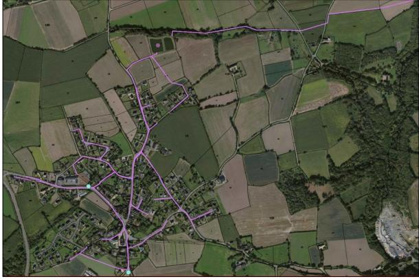
Figure 13 - Réseau d'assainissement (Eaux Usées) de Camlez (Source : LTC)
