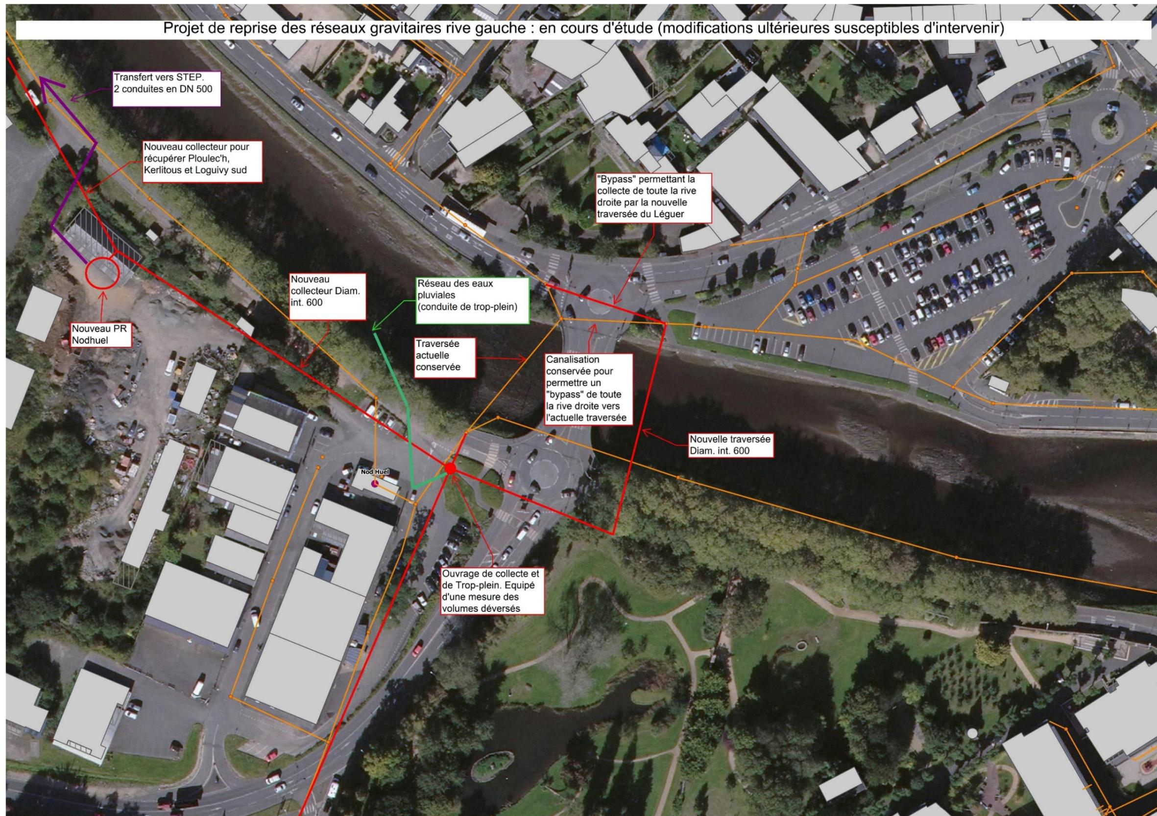
Figure 6 : Plan de projet de reprise des réseaux en rive gauche
