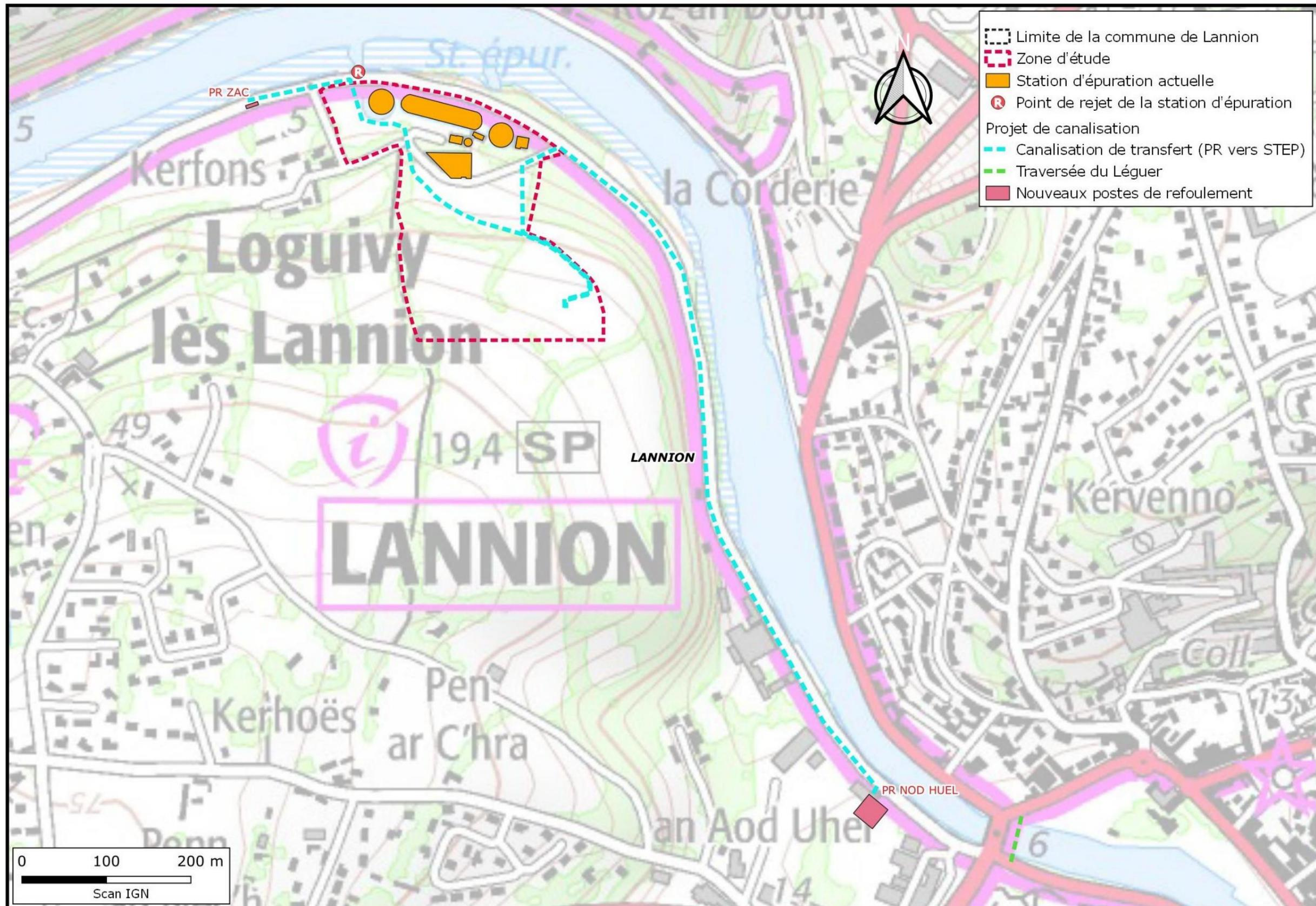
Figure 9 : Plan de projet des nouvelles canalisations de transfert entre les nouveaux PR (Nod Huel et ZAC) et la future STEP
