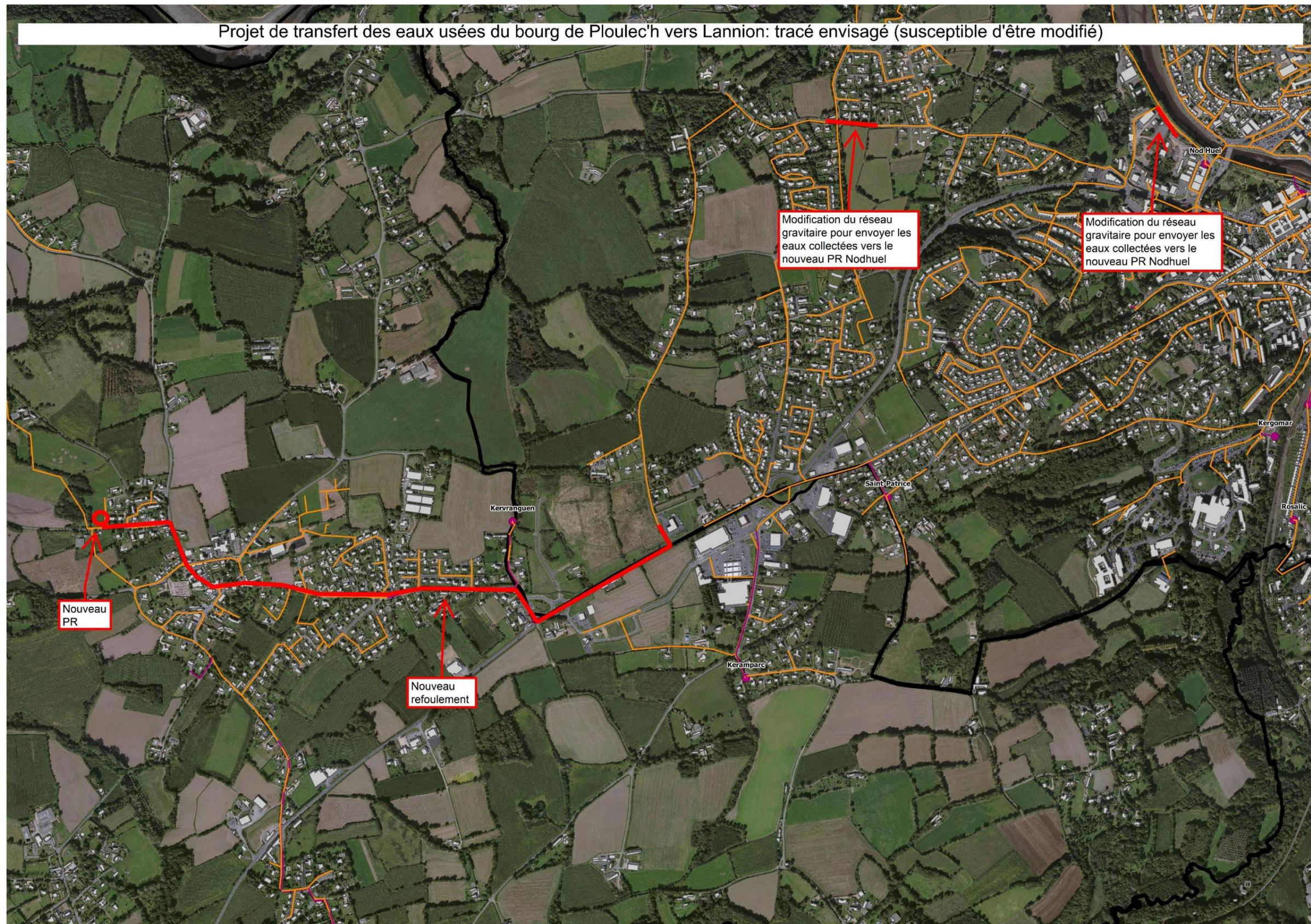
Figure 10 : Plan de projet du réseau de transfert des eaux usées du bourg de Ploulec'h vers le PR Nod Huel
