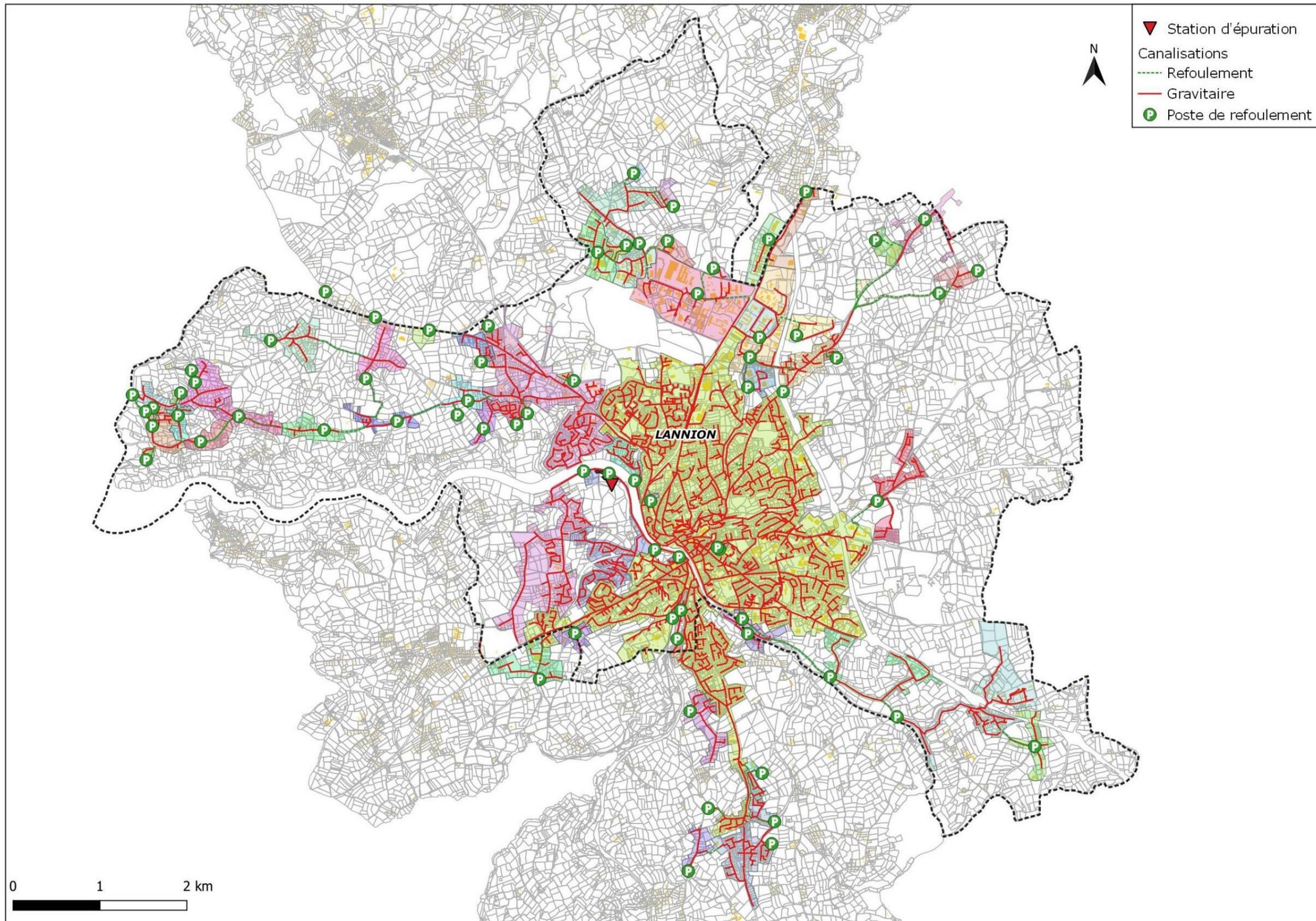
Figure 5 : Localisation des postes de refoulement du réseau de collecte raccordé à la station d'épuration de Lannion
