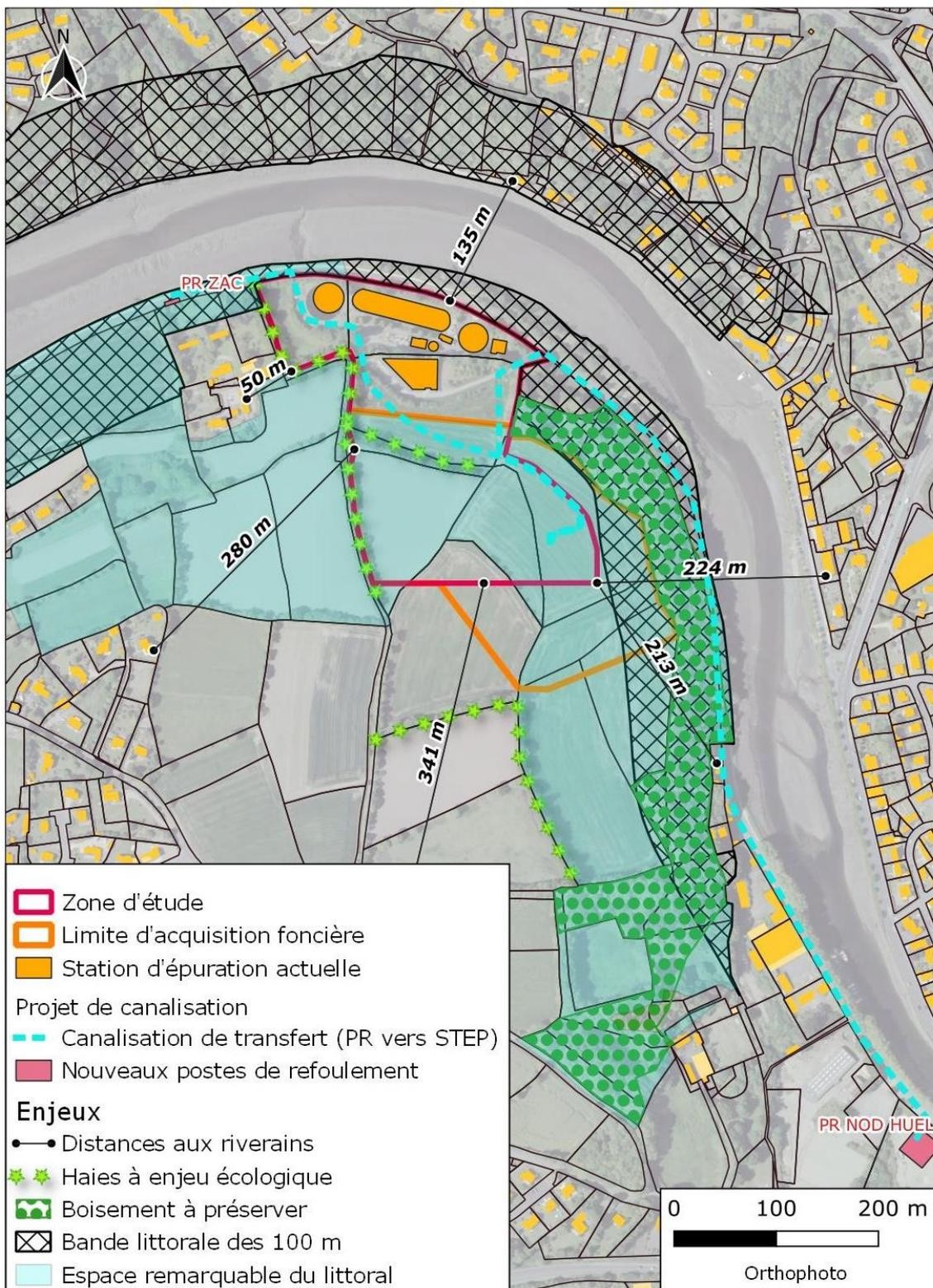
Figure 13 : Enjeux sur et aux abords proches du site de la future station d'épuration
