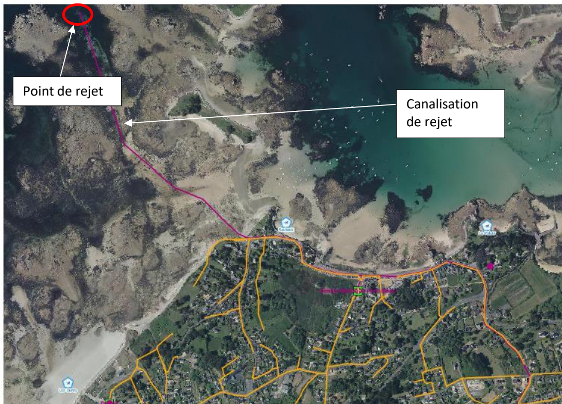
Figure 87 : Localisation des zones de baignade par rapport au point de rejet (LTC)
