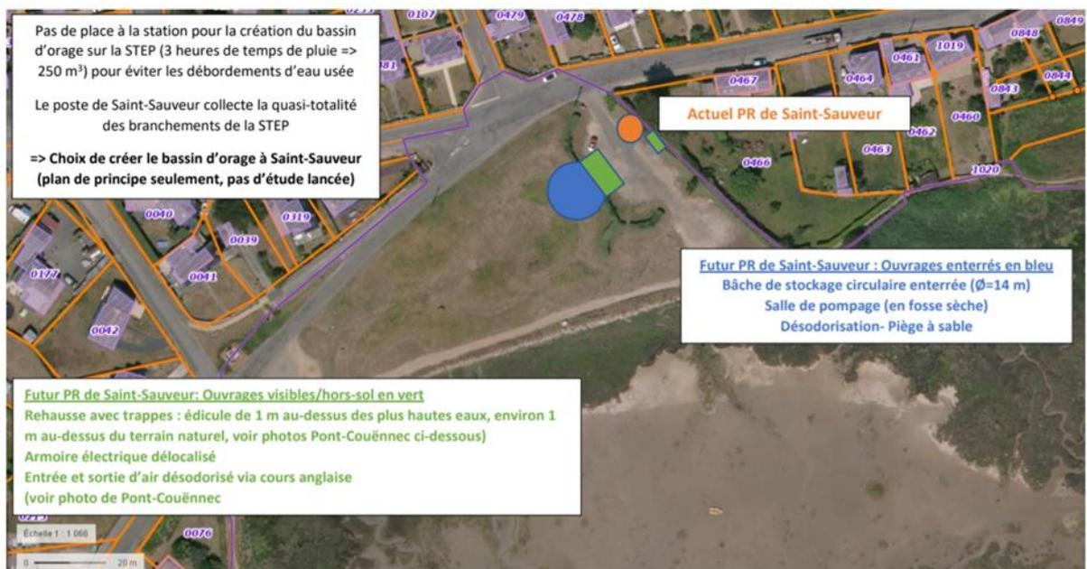
Figure 49 Localisation du poste de St Sauveur – STEP Ile Grande
