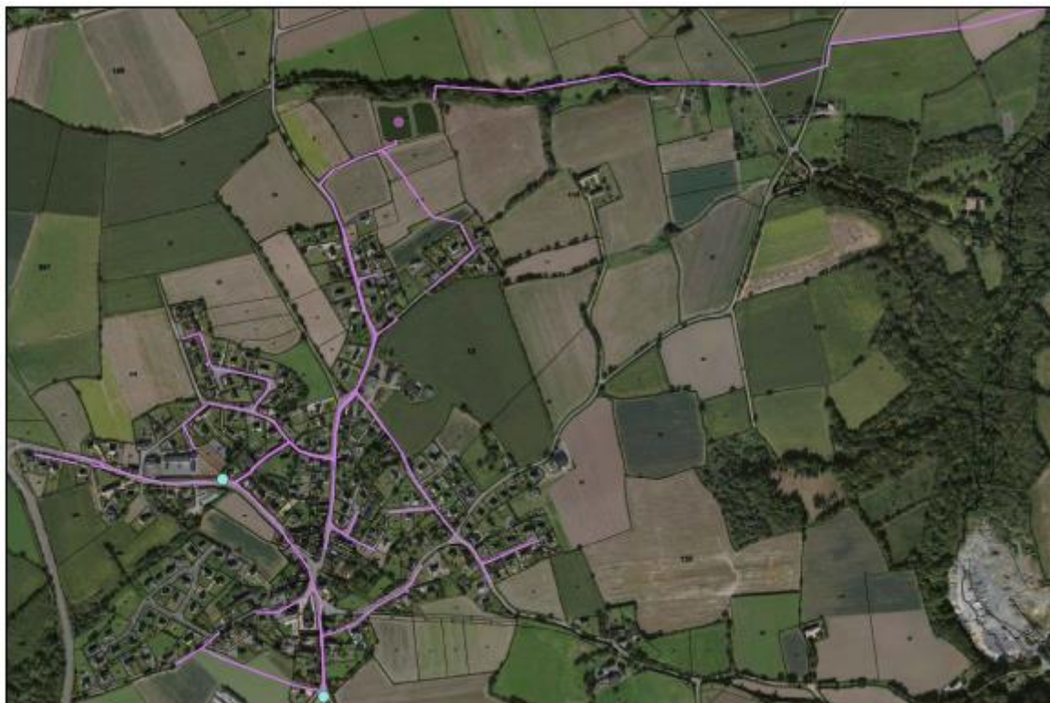
Figure 25 : Réseau d'assainissement de Camlez
