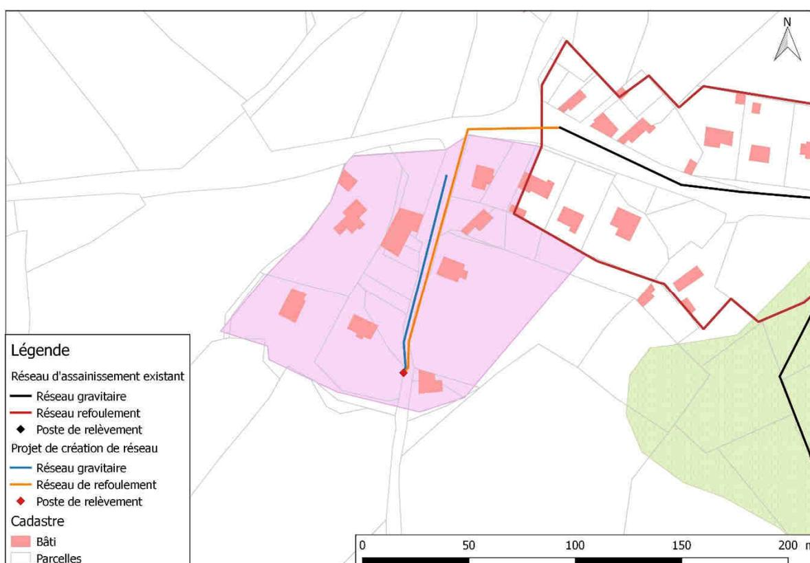
Figure 88 : Projet de raccordement du secteur de Penn Ar Hoat à la station de Kerbabu
