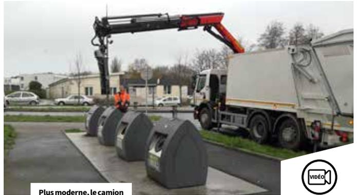
Plus moderne, le camion grue charge jusqu'à 8,5 tonnes de déchets contre 4,5 par le passé.
