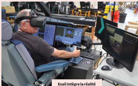
Exail intègre la réalité augmentée sur ses simulateurs afin de coller au mieux aux sensations réelles.
