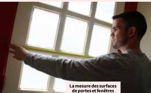
La mesure des surfaces de portes et fenêtres est un élément de l'évaluation thermique d'une maison.
